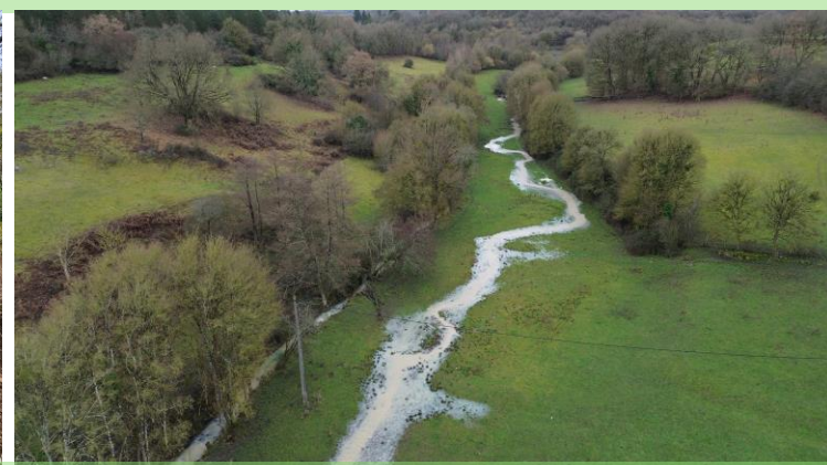
Mise en œuvre d'une solution fondée sur la nature visant la remise en fond de vallée du cours d'eau, par la création d'un ouvrage castor mimétique (OCM) – (dénomination distinguée par la DDT86 de celui de barrage). Il est réalisé à partir de terre et de branches prélevées sur site, afin de favoriser les débordements et permettre la reconnexion des écoulements en fond de talweg.
